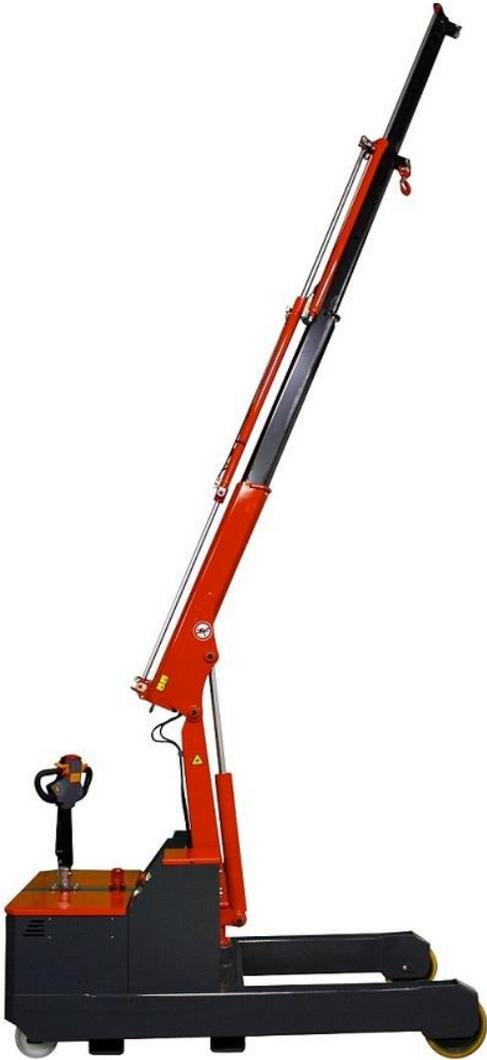
Los modelos OMNIA 2TL y 2TR son grúas Pick & Carry totalmente eléctricas con una capacidad máxima de 2000 kg y triple extensión eléctrica lo que permite que el brazo se extienda hasta 3 metros. Una de las características clave de estos modelos es que no hay estabilizadores laterales, por lo que estas grúas ofrece la máxima movilidad con carga suspendida.
