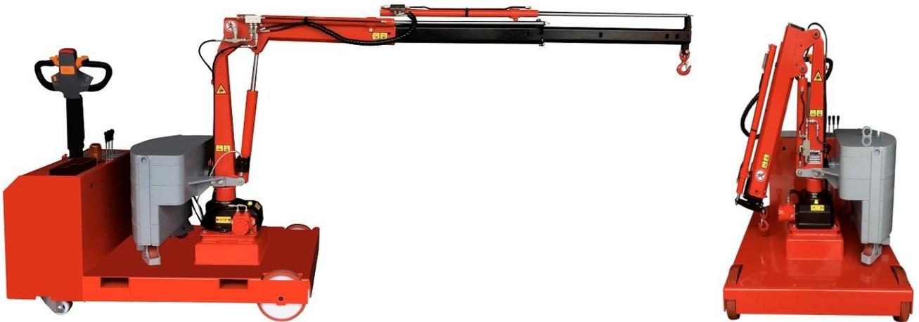
Los modelos ORBIT 200EL y ORBIT 200ER son grúas pick & carry giratorias, totalmente eléctricas, con una capacidad máxima de hasta 200 kg. Una de las características clave de esta grúa pick and carry es que no hay estabilizadores laterales, por lo que esta grúa ofrece la máxima movilidad con carga suspendida.
