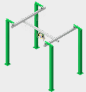
Puente grúa montado en columnas
